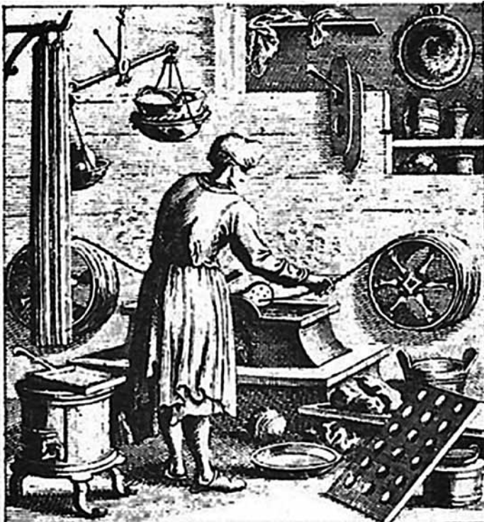
Einfache Ziehtrommel, in der Mitte kohlenbeheiztes Wachsbad, (Stich, Anfang 18. Jh.)
